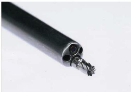
Fig. 3. An example of an integrated robot arm, comprising a drill, endoscope, and two ports for irrigation and suction. (From Wurm J, Bumm K, Steinhart H, et al. Entwicklung eines aktiven Robotersystems für die multimodale Chirurgie der Nasennebenhöhlen. HNO. 2005;53(5):446-454; with permission.)
